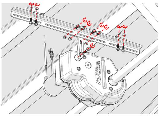
D. INSTALL CONTROL ENCLOSURE AND BRACKET
